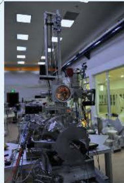
超高真空、超高精度二维样品台及样品传送系统
