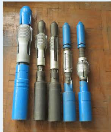
事故处理工具-可退式打捞矛
