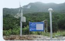
三峡库区白家湾滑坡监测站
