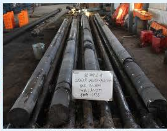
单回次超30m长、直径214mm的原状岩心
