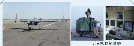
彩虹3型无人机航空物探（磁/放）综合勘查系统
