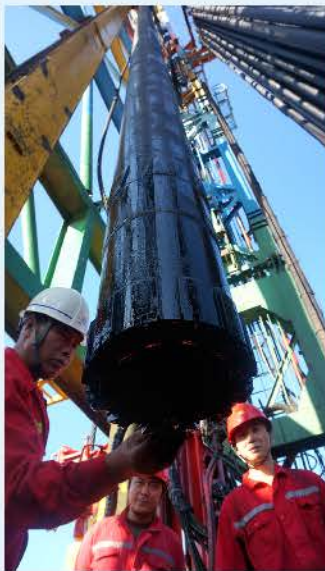
30m长KT-298钻具满管出井
