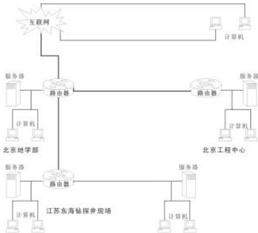
图1 中国大陆科学钻探工程网络拓扑图
