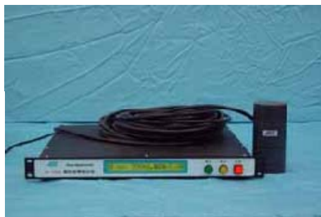
自主研发的HC-2000汞光泵磁力仪
