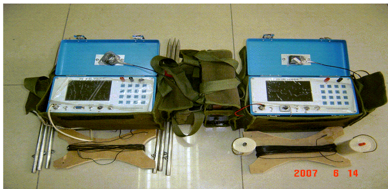
仪器轻便，采用偶极装置，整套设备35kg,便于普查及地形恶劣地区工作
