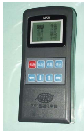
自主研发的磁化率仪
