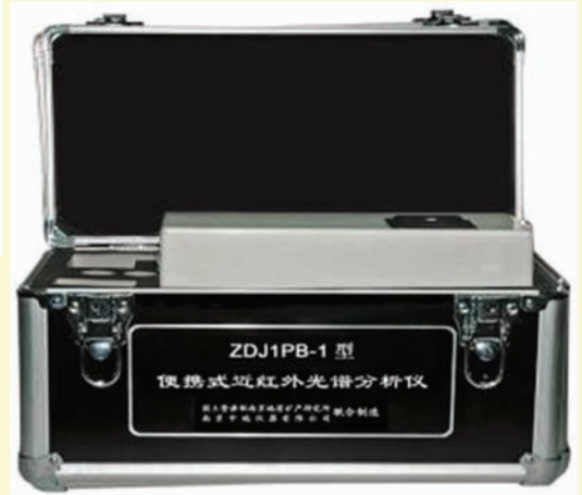
图 3-12 ZDJ1PB-1 型便携式近红外矿物分析仪及携带箱
