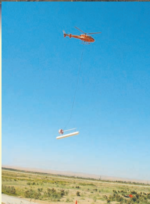
图1-7 频率域航空电磁系统进行作业
