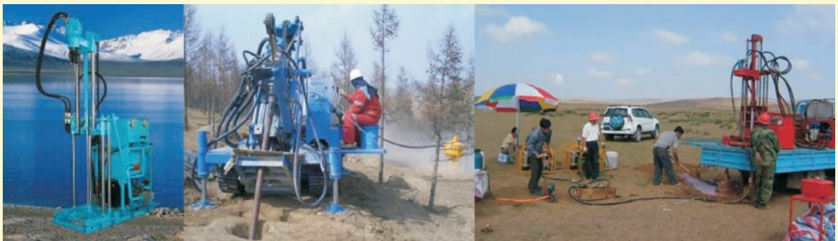
图 4-14 勘探所 DR 系列全液压取样钻机
