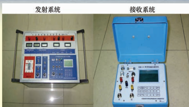
图 1-22 大功率多功能电磁法系统
