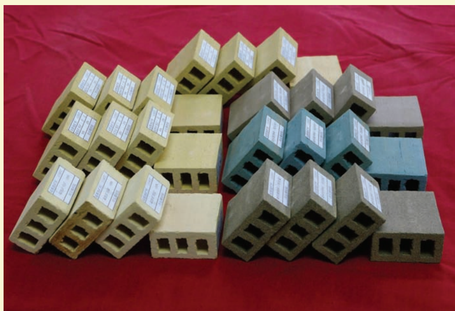
图 6-11 硫铁矿选矿尾矿制作烧结墙体砖
