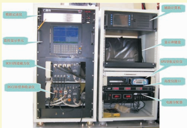
图 1-3 HC05 和 DSC02 等组成的航磁全轴梯度测量系统
