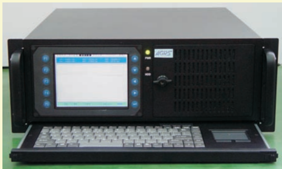
图 1-2 DSC1 型航磁数字补偿仪与数据收录系统
