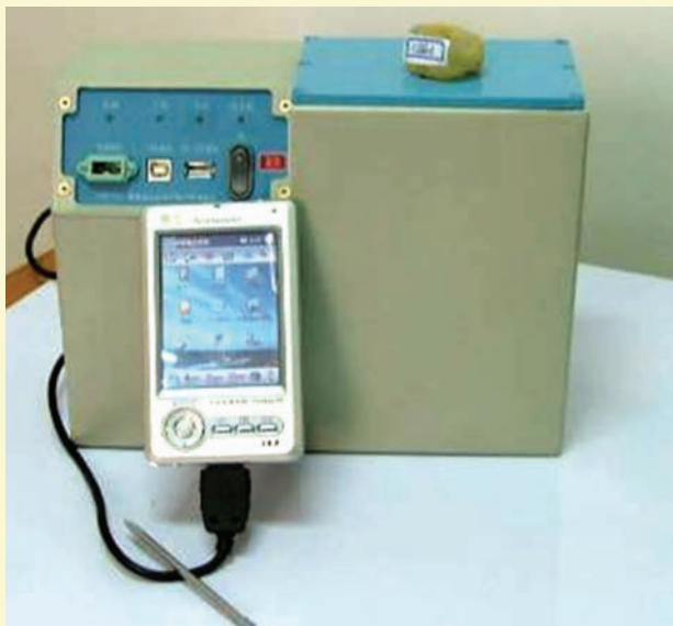
图 3-11 BJKF-1 型便携式近红外矿物分析仪样机
