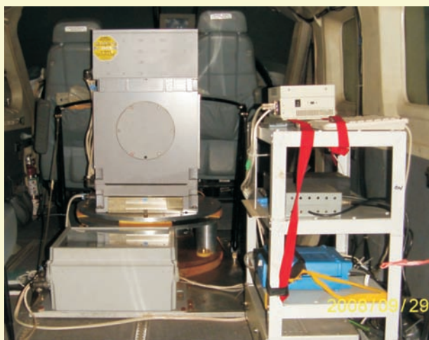
图 1-6 GT-1A 航空重力测量系统
