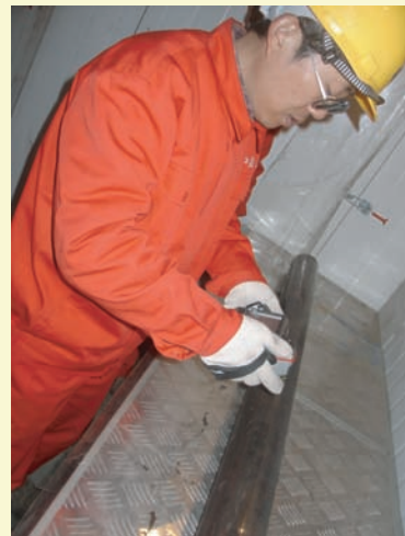
图 2-56 现场实验室内利用红外热像仪对封装于 PVC 管中的岩心进行扫描
