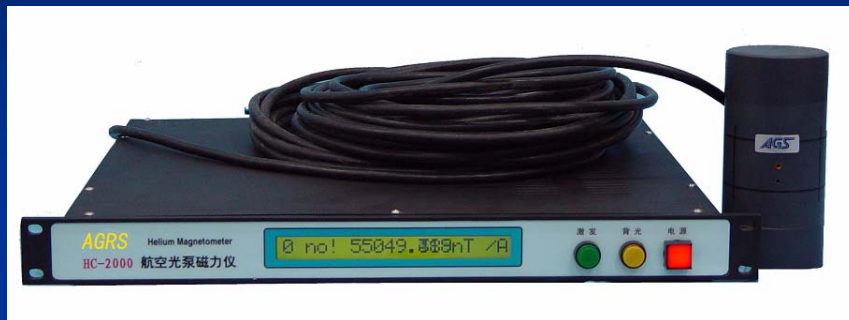
自行研制的 HC-2000 氦光泵磁力仪, 灵敏度 2.5pT
