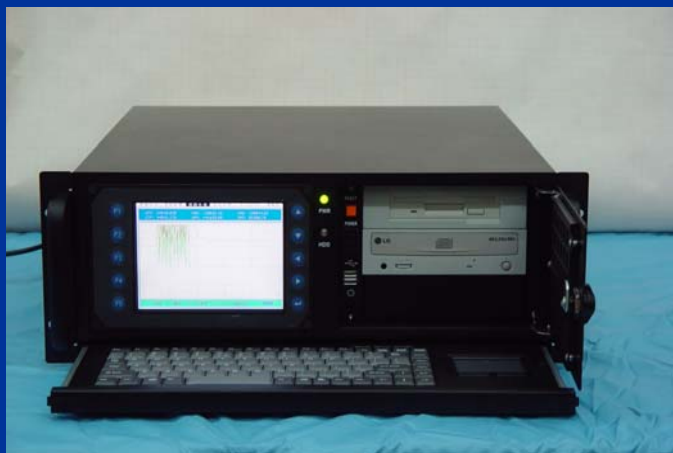
自行研制的航磁数字补偿-数据收录一体化系统
