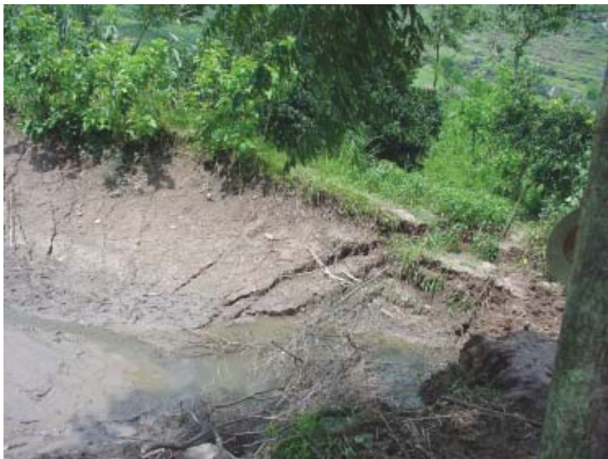
滑坡体上的池塘极易拉裂，导致地表水渗入滑坡内，加剧滑动（重庆云阳，2001）
