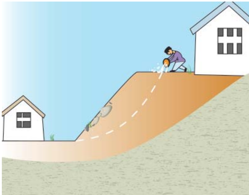
在滑坡体上随意泼水增加了下滑力，容易引发灾害
