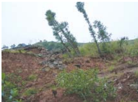
滑坡体上的树木歪斜，像醉汉一样，东倒西歪，显示滑坡已滑动解体（四川宣汉，2004）
