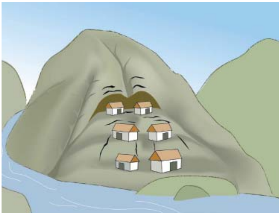
大量裂缝的出现，说明山坡已处于危险状态
