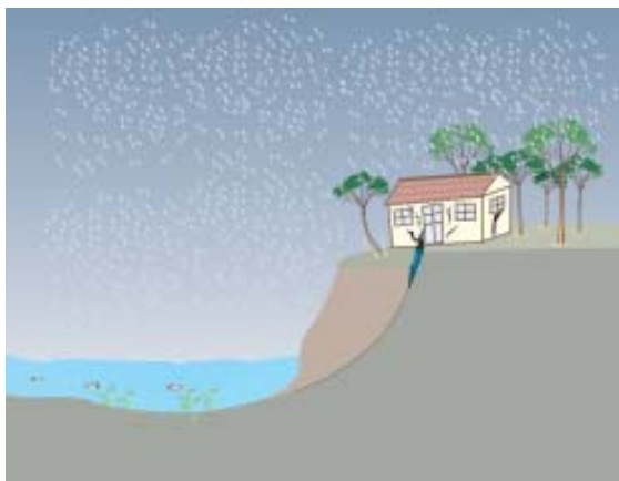
降雨诱发滑坡，建在岸边的房屋被破坏
