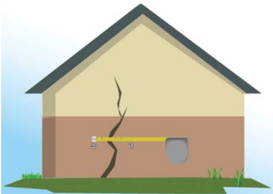
埋钉法(在建筑物裂缝两侧各钉一颗钉子，通过测量两侧两颗钉子之间的距离变化来判断滑坡的变形滑动)
