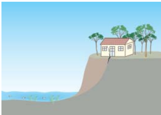
河流冲刷陡坡坡脚，建在岸边的房屋非常危险
