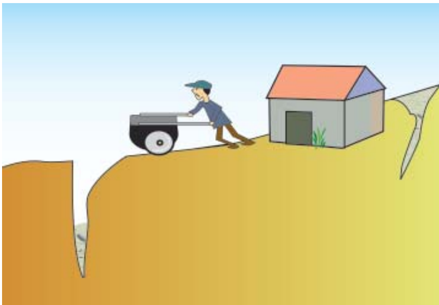
应及时填埋滑坡体上的裂缝
