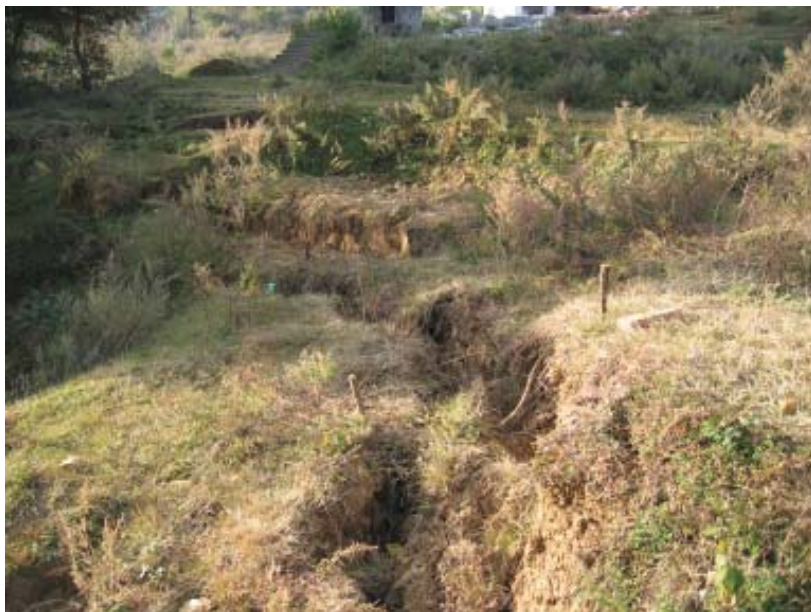
在裂缝两侧埋置木桩，可以量测滑坡变形拉裂（云南保山，2005）
