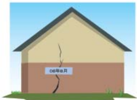
在横跨建筑物裂缝粘贴纸片监测裂缝拉裂
