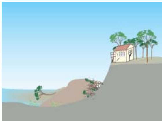
新选场址应尽可能避开江、河、湖（水库）、沟切割的陡坡地带
