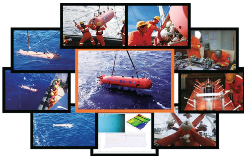
“潜龙一号”6000米无人无缆潜器(AUV)成功应用于合同区多金属结核资源调查
