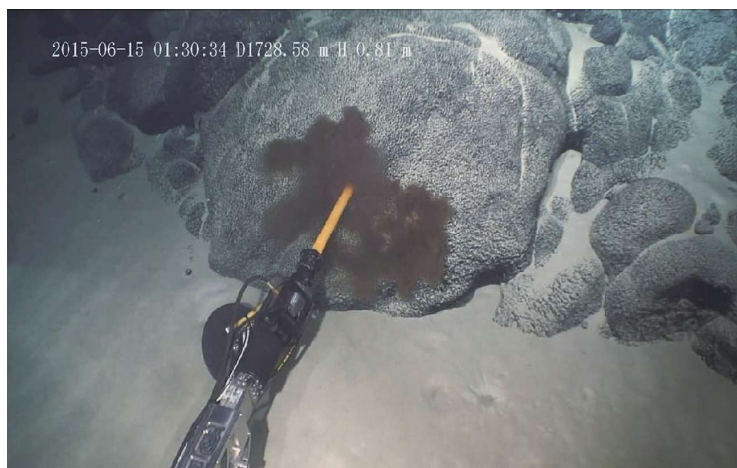
“海马”号在采薇海山进行结壳钻机取样试验
