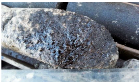
巴油砂1井岩心裂隙见深褐色原油渗出
