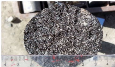
巴油砂1井侏罗系克孜勒努尔组油砂岩心断面饱和含油
