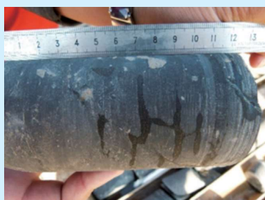
743米灰黑色粉砂质泥岩层面和裂隙中见油
