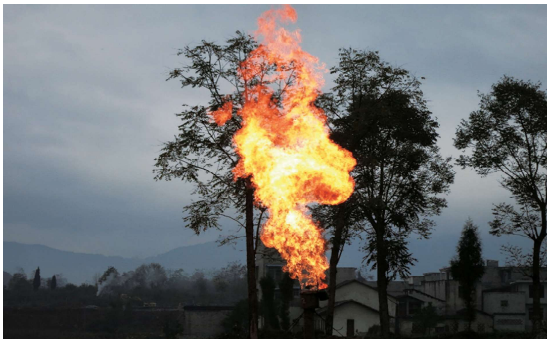
安页1井钻探过程中点火照片
