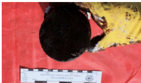
鱼油砂1井侏罗系采石岭组油砂岩心断面含油面积90%~100%
