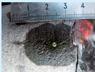
505米灰色中砂岩心表面冒出黄色油泡
