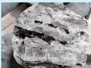
815米流纹玢岩脉裂隙中的沥青
