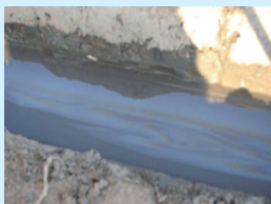
钻井深730米泥浆槽面的油花
