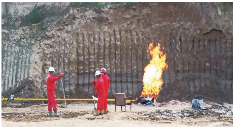
宜参1井压裂试气放喷点火现场
