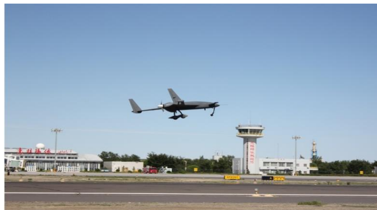
彩虹3无人机航空磁放综合测量系统
