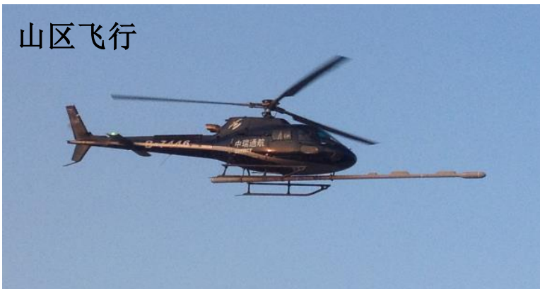
小松鼠AS350直升机及航空重磁综合测量系统
