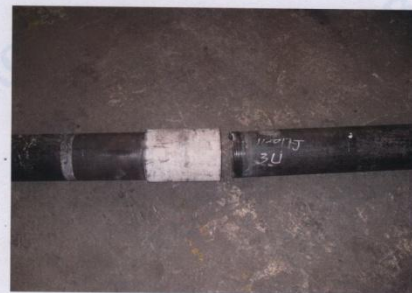
图 2 试样 3U 拉伸至失效后形貌
