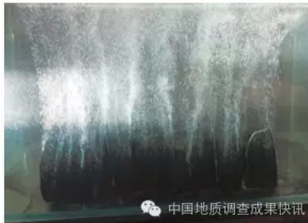
秭地2井岩心水浸试验剧烈气泡
