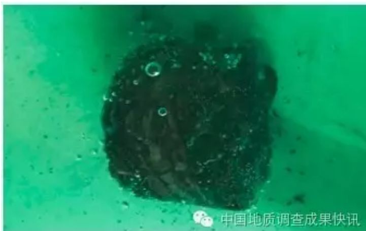
武威1井1491m泥岩岩心浸水实验强烈起泡
