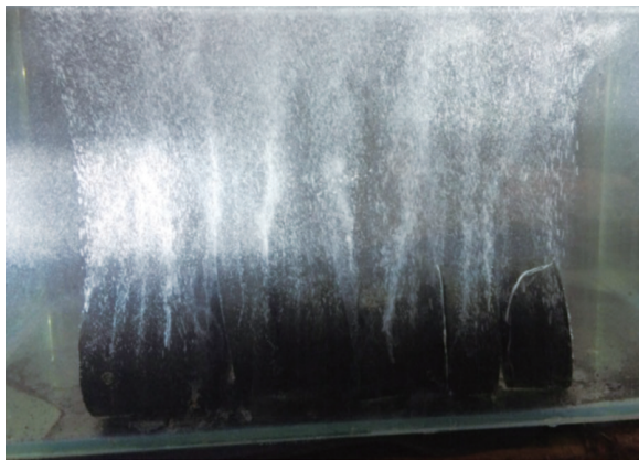
秭地2井岩心水浸试验剧烈气泡
