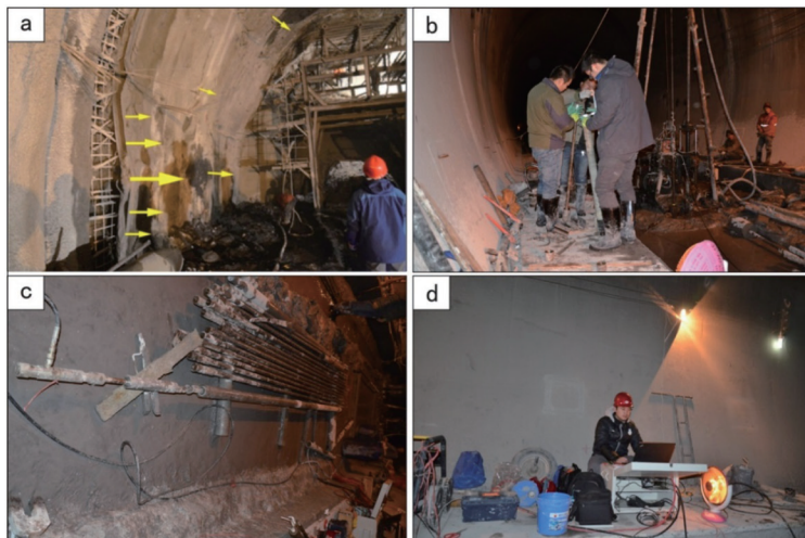
兰渝高铁木寨岭隧道大变形特征与关键点水压致裂地应力测量
