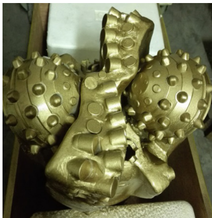
8-1/2" 牙轮 -PDC 复合钻头实物
