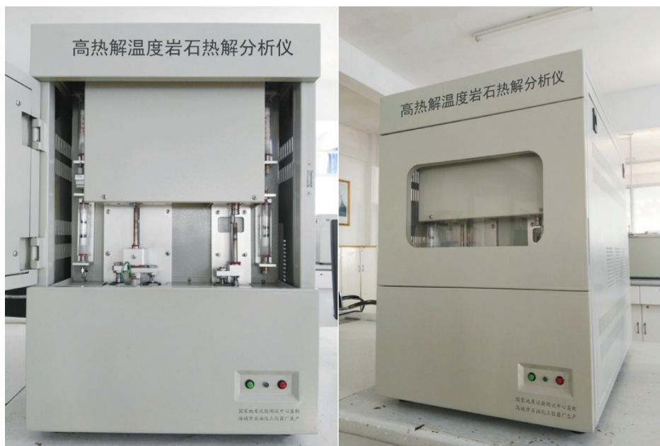
高热解温度岩石热解分析仪样机实物
