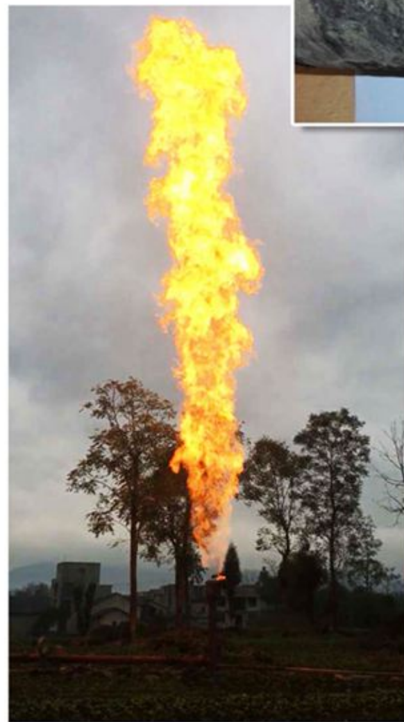
石牛栏组放喷点 火，火焰高30m
