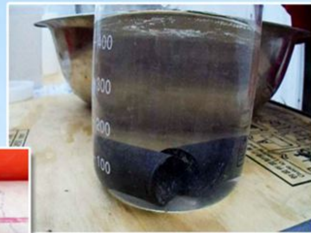
栖霞组1193m井壁取心 浸水试验串珠状气泡
