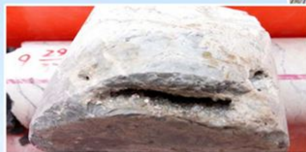
奥陶系宝塔组灰岩缝洞照片
