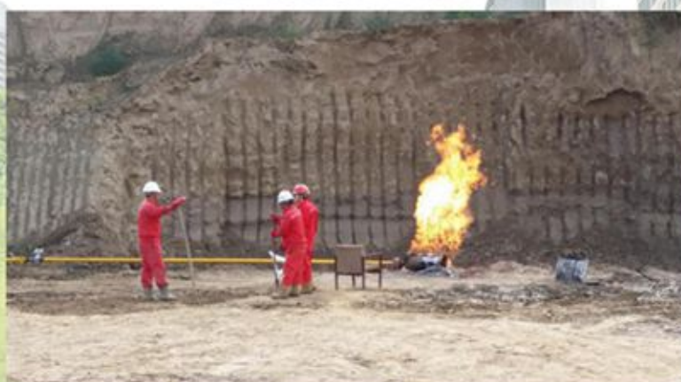
宜参1井酸压试气点火照片
