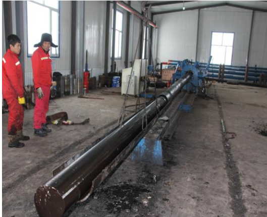
液压顶推机构辅助的粗大岩心
