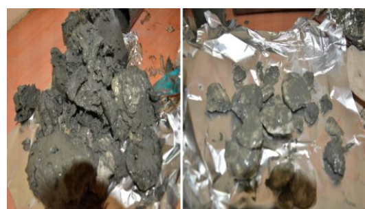
在“海马冷泉”区 ROV2 站位采集的海底沉积物中的块状水合物样品
